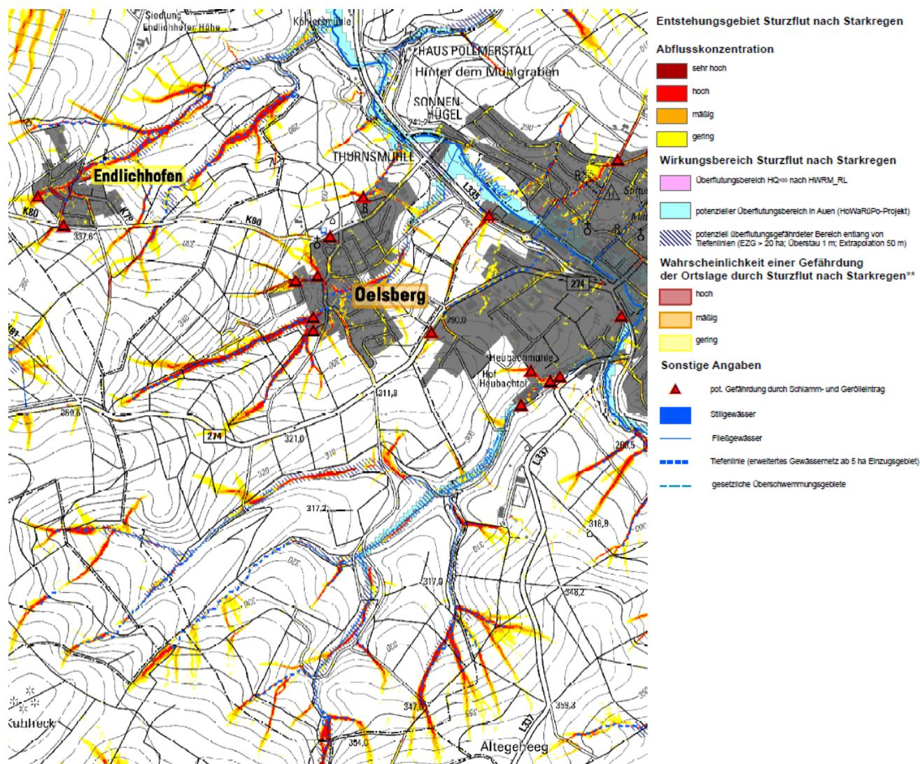
Abbildung 10: Gefährdungsanalyse Sturzflut nach Starkregen, Karte 5 (LfU, 2020)
